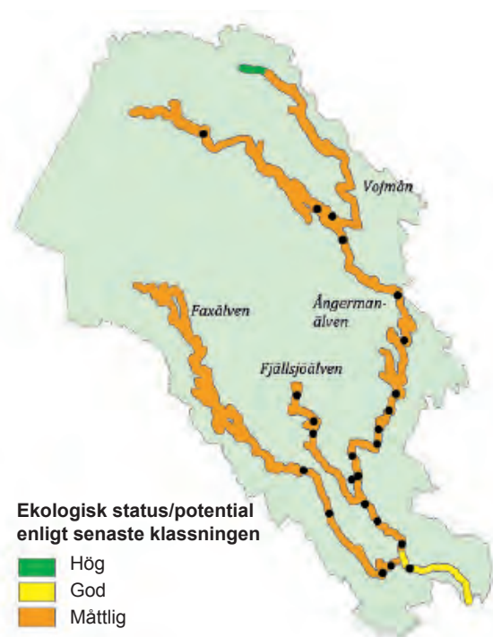
Figur 28. Preliminär statusbedömning enligt VISS av ekologisk potential i de delar av Ångermanälven som berörs i våra tre rapporter. Större delen av huvudfåran och de stora biflödenas nedre delar är således kraftigt modifierade vatten och deras status är otillfredsställande.
